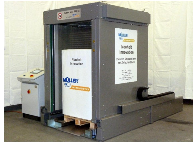
Kabine auf Zielposition (Zwischenblech rausfahren)
