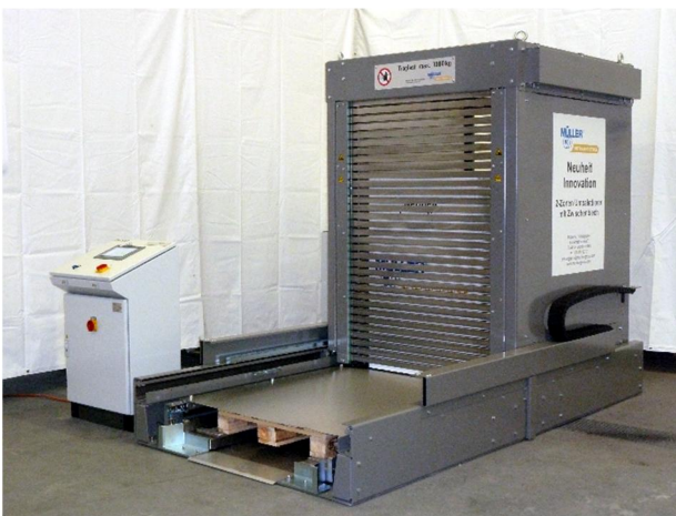
Mit Zwischenblech abgedeckte Zielpalette; beladene Quellpalette (hinten)
