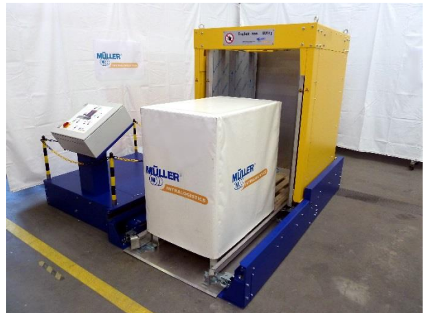
Zwischenblech hervorziehen und Kabine in Grundposition
