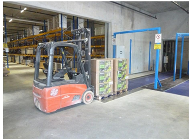
Aufgabe mittels Gabelstapler
