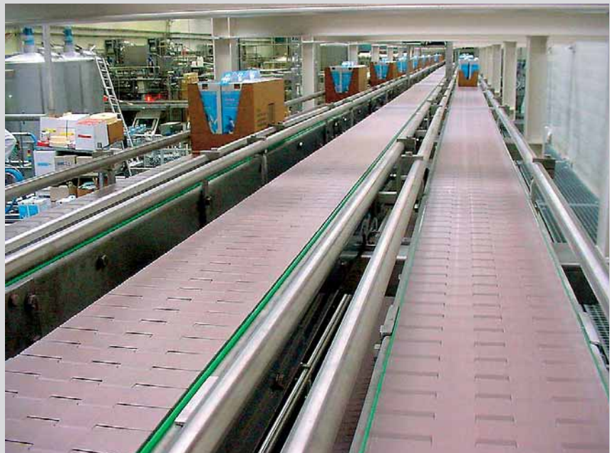
Bild 3: Transportstrecken zur Palettieranlage
