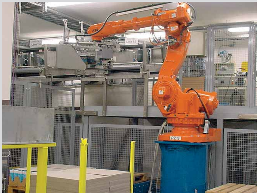
Bild 2: Palettierroboter in Übernahmestellung
